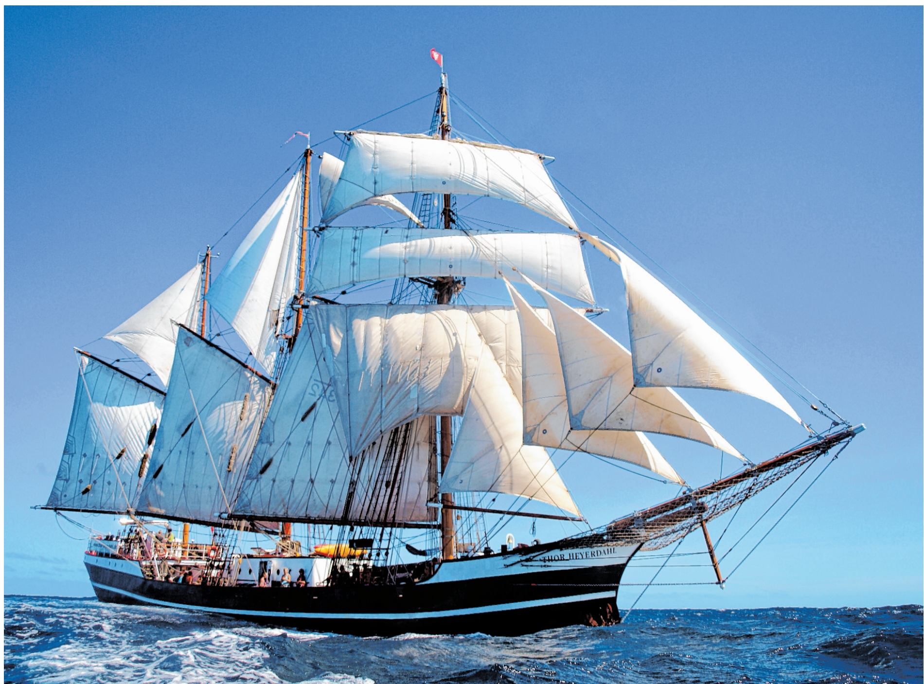
Das Schulschiff Thor Heyerdahl: Gut 40 Meter lang ist der Windjammer, 1930 in Holland als Küstenmotorschiff mit Hilfssegeln gebaut und später umgerüstet.
